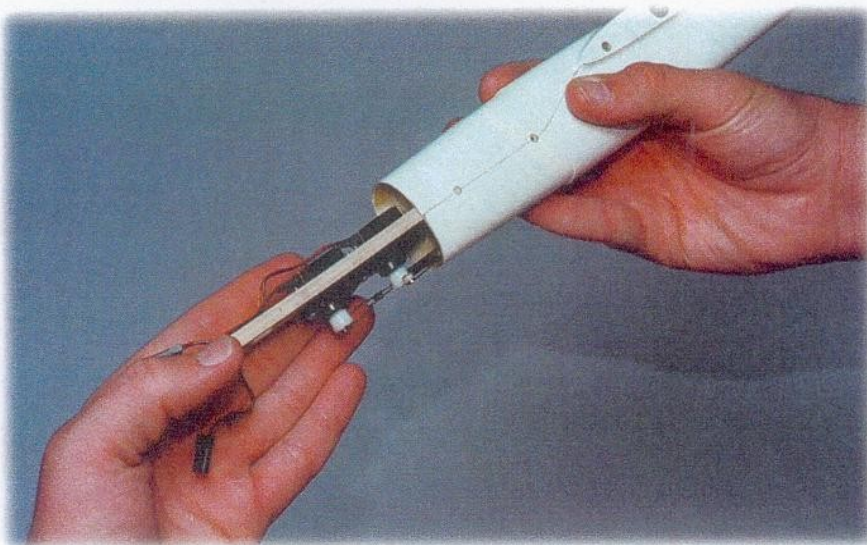
Elegant: Nur vier Schrauben sind nötig um die Platine demontagefreundlich zu fixieren. Die Servos sind in hängender Position eingebaut.
