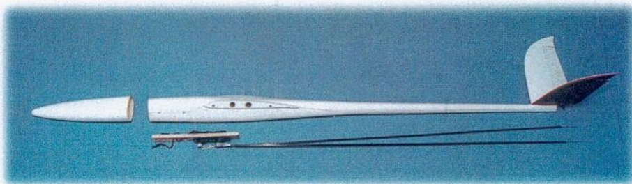
Die Einbaukomponenten des Rumpfes auf einen Blick: Das fertige Servobrett wird samt den CFK-Schubstangen in den Rumpf geschoben und mit vier Schrauben fixiert.
